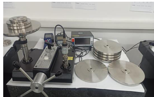
Figura 4. Montimi i të gjithë sistemit matës të sensorit të presionit
